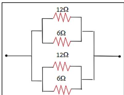
8. Analise o circuito elétrico abaixo e determine o valor da resistência equivalente.
